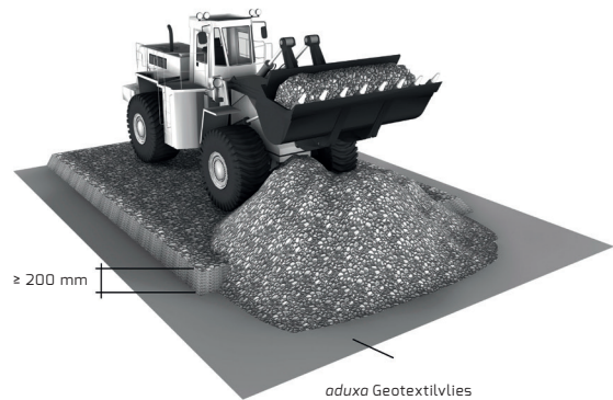
Abb.5 Einbringen des Schüttmaterials vor Kopf
