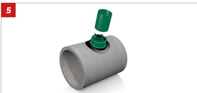
**5 | Das angefastete Spitzende des Anschlussrohr DA 160 mit Gleitmittel bestreichen und bis zum Anschlag einstecken.**
