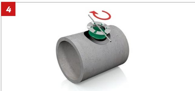
**4 | Anschlussstutzen gleichmäßig und zentrisch mit dem Bedienschlüssel (Zubehör) bis zum letzten Gewindegang in die Kompressionsdichtung einschrauben.**
